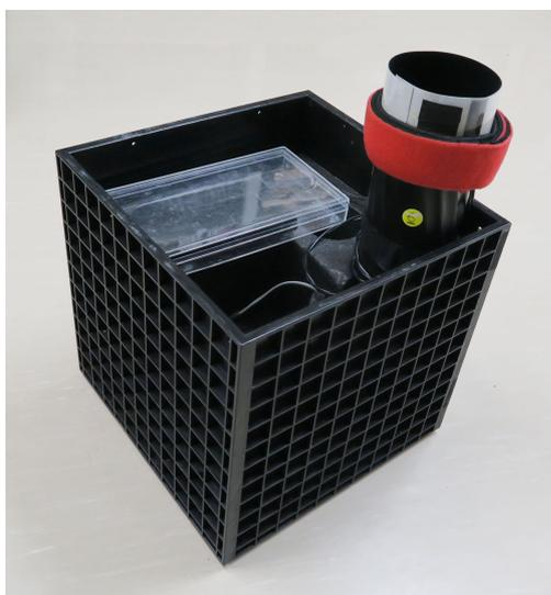
図 1. SQM 設置に用いた測定ボックス（山本ほか，2017）。円筒状の筒の中に SQM-LU-DL がバッテリーとともに納められ、短起毛フットが取り付けられている。筒の先端には光学ガラスフィルターが取り付けられており、夜露防止のためのウォーマがまかされている。ウォーマの電源として USB モバイルバッテリーを用いている。
