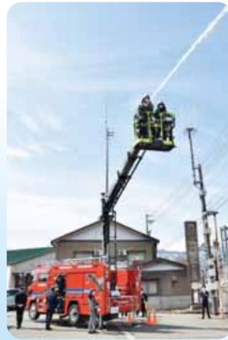
勝山市に新しく多目的消防ポンプ自動車が納車されました。屈折ブームとバスケット装置を備え、様々な災害に対応できるうえ、圧縮空気泡消火装置も備えており、少量の水でも高い消火効率を発揮します。
