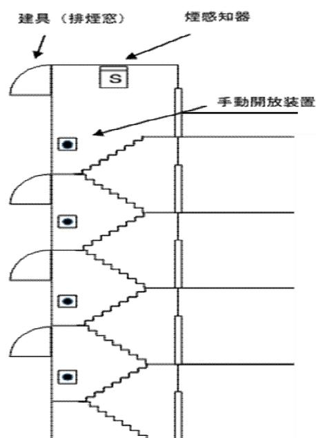
第16-60図 各階の中間の部分ごとに建具を設置する例
