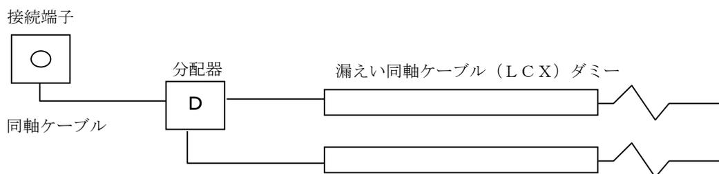
第23-2図 漏えい同軸ケーブル方式
