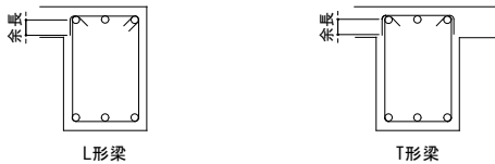
図2-3-4 あばら筋・帯筋の形状(溶接閉鎖形の場)
