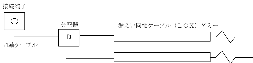
第23-2図 漏えい同軸ケーブル方式
