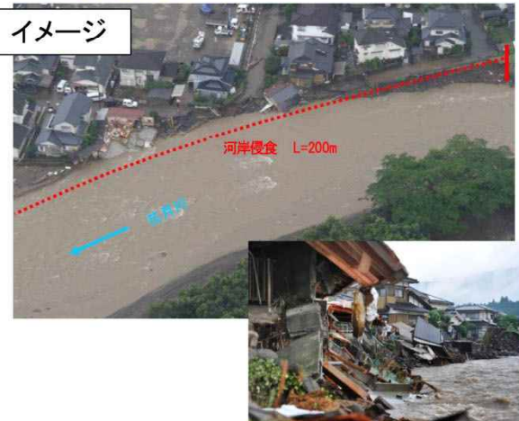
河岸侵食により家屋倒壊した状況
