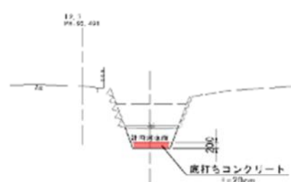
底打ちコンクリート(溢水なし区間)
