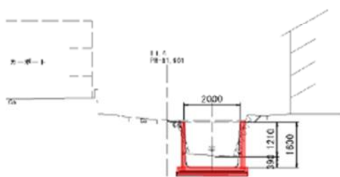
大型フリーム(断面狭小 溢水区間)
