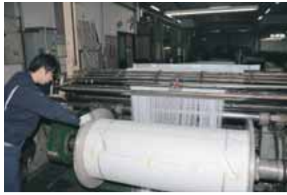
糊付け糸を巻き上げ、発注先に出荷します
