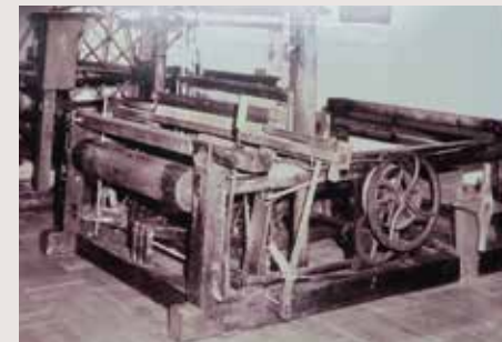
木製の力織機（駆動部分は鉄製）
