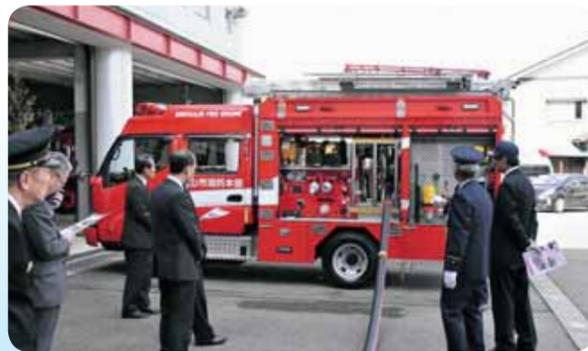
老朽化に伴い、消防ポンプ車を更新しました。新車両は横方向から吸水管を採用したため、ホース操作が一人で行えるようになりました。
