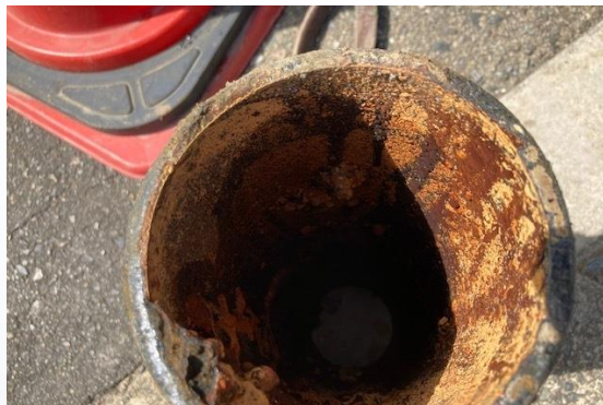
ダクトイル鋳鉄管の状況（ダクトイル鋳鉄管の漏水等は、今のところなし）
