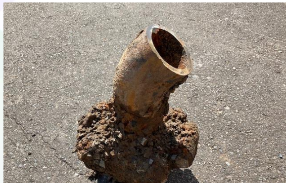
ダクトイル鋳鉄管の状況（ダクトイル鋳鉄管の漏水等は、今のところなし）
